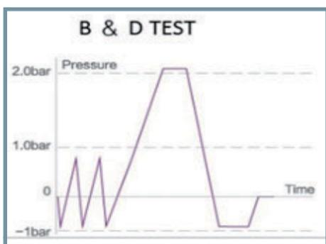
Diagrama de B & D em autoclave pré-vácuo
