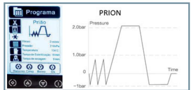
Tela e diagrama de teste PRION em autoclave pré-vácuo
